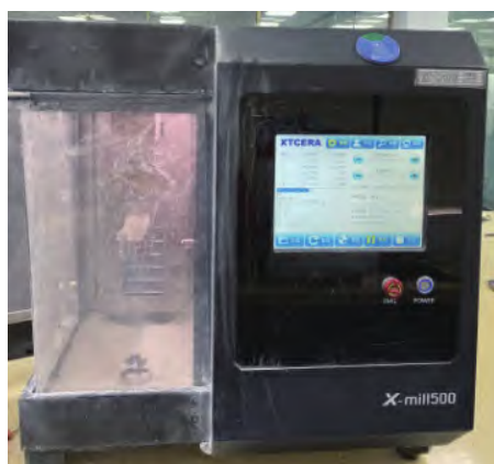
图 3 CAD/CAM 切削制作树脂暂时冠
